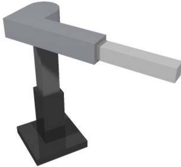
Figura 3.14 - Braço robótico cilíndrico
